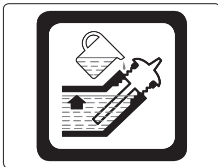
Obr.5, výška hladiny oleje v olejové nádrži
