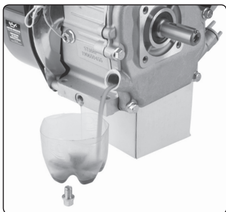
Obr.9, ilustrační obrázek umístění stroje pro vypouštění oleje
